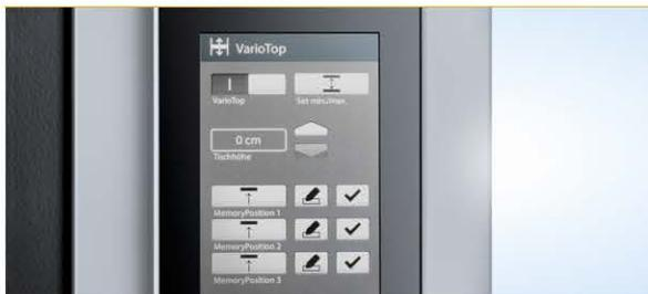
Automatische Einstellung und Programmierung individueller Arbeitshöhen bei wechselnden Anforderungen wie Sitz-/Steharbeitshöhe oder unterschiedlich hoher Versuchsaufbauten im Innenraum.
