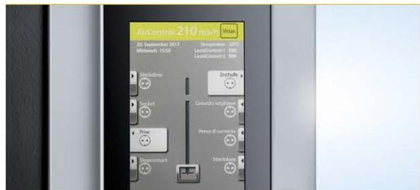
Die vollvariable Abluftregelung sorgt dafür, dass die benötigte Abluft gerade so hoch ist, wie die Sicherheit es erfordert.
