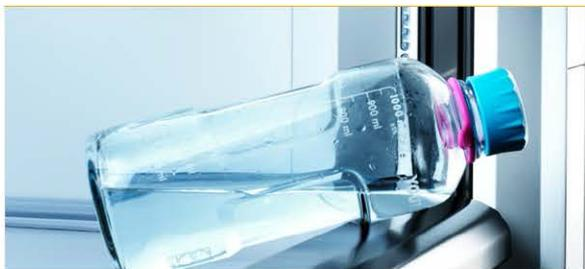
Sorgt dafür, dass der Frontschieber sich nicht automatisch schließt, solange etwas in den Abzug hineinbeziehungsweise aus ihm herausragt.
